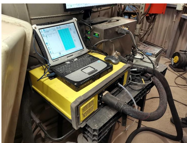
Joonis 1. Gaasianalüüsi mõõtekoht: vasakul – gaasianalüsaatori mõõtepea, paremal – gaasianalüsaator
