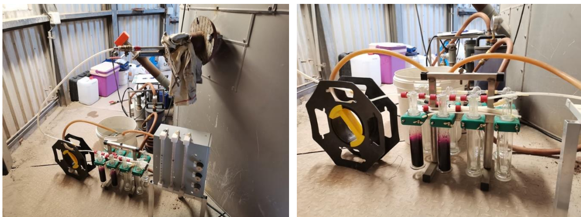
Joonis 2. Raskmetallide proovide võtmine: vasakul – tahke proovi kogumine filtritele ja gaasi absorbeerimine, paremal – gaasi absorbeerimine lahustesse
