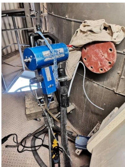
Joonis 1. Gaasianalüüsi mõõtekoht: vasakul – gaasianalüsaatori mõõtepea, paremal – gaasianalüsaator
